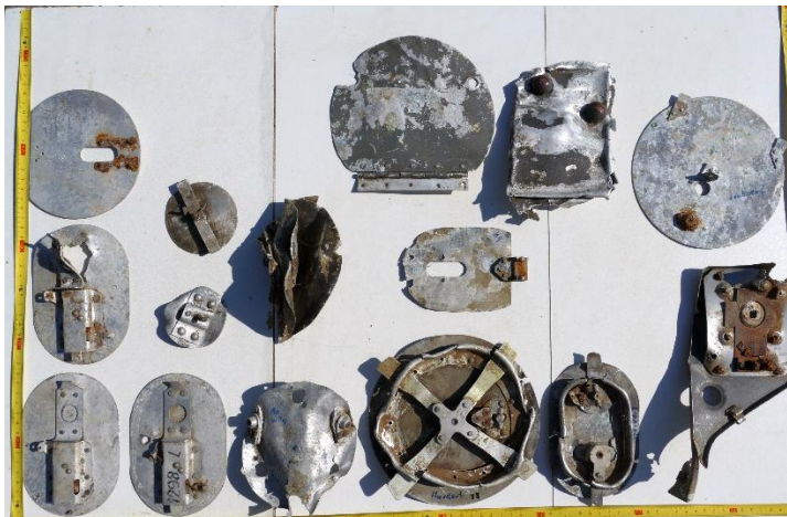
Normteile Beispiel für Handlochdeckel
